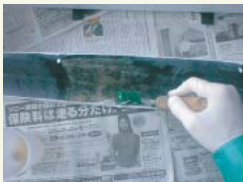
バンパー裏面からガラスマットを貼り樹脂を染み込ませながらローラーで空気を抜いていきます。
