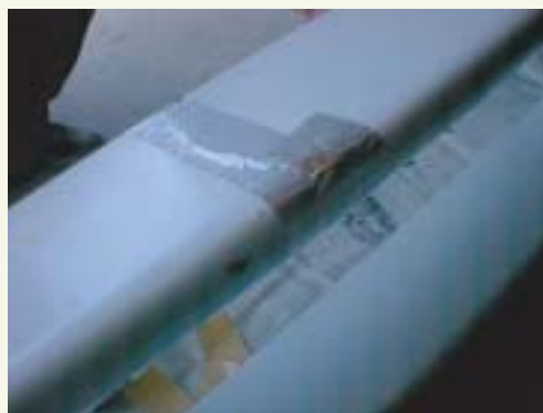
バンパーの表面に元の形に合わせる感じにアルミテープを貼っていきます。
