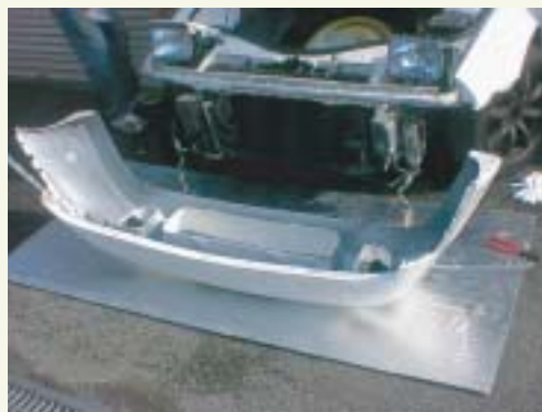
バンパーの裏側からガラスマットを貼っていくので基本的にバンパーを外した方が作業がしやすい。
